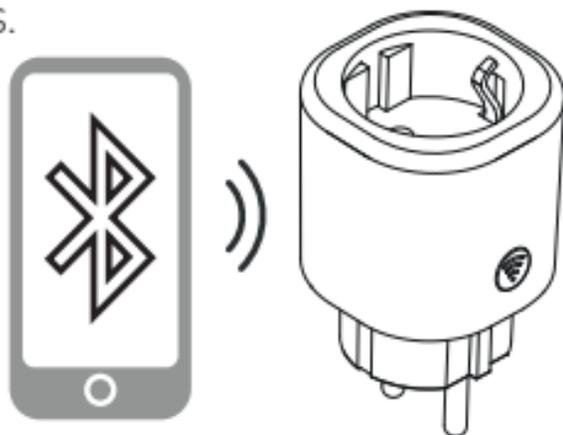
**4** Después de estos 5 segundos, el LED deberá cambiar a color Azul. Cuando esto ocurra, conecte con el wBridge para configurarlo.
